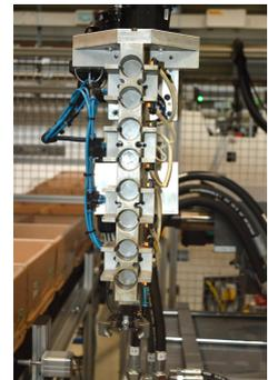
Achtfach-Handlingkopf mit Greiferstationen zur beschädigungsfreien Entnahme von Spritzgussteilen aus einer Maschine. (Bild: ipf electronic)
