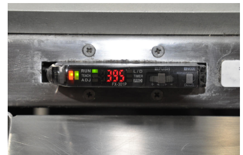
Detailansicht des Verstärkers. Der angezeigte Wert gibt die Signalstärke der Lichtschranke bei Unterbrechung des Lichtsignals wieder. (Bild: ipf electronic gmbh)
