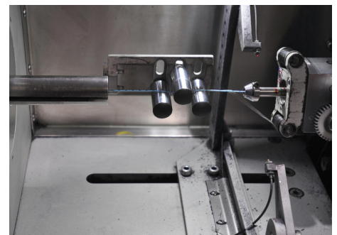
Aufnahme bei angehaltener Maschine. Die transparente Folie (hier unterhalb des Spinnkopfes) wird um die Ader gewickelt. Kontinuierlich überwacht wird die Unterbrechung der Lichtschranke. (Bild: ipf electronic gmbh)
