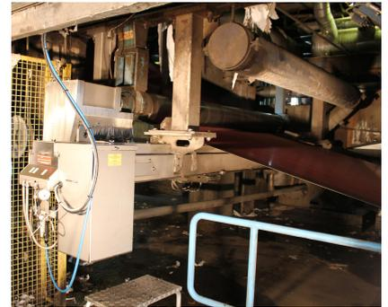
Blick in eine Papiermaschine. Rechts ist ein Teil der durch Walzen unterstützten Maschinenbespannung zu sehen. (Bild: IBS Paper Performance Group)
