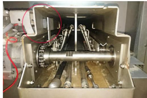
Die beiden induktiven Sensoren **IB1201K0** zur Wegmessung und Abfrage der Drehrichtung sind vor einer Kodierscheibe an der Antriebswelle (links) des Kettenantriebs montiert. (Bild: IBS Paper Performance Group)
