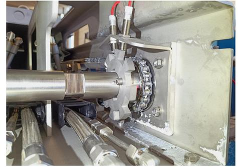
Die beiden induktiven Sensoren **IB1201K0** zur Wegmessung und Abfrage der Drehrichtung sind vor einer Kodierscheibe an der Antriebswelle (links) des Kettenantriebs montiert. (Bild: IBS Paper Performance Group)
