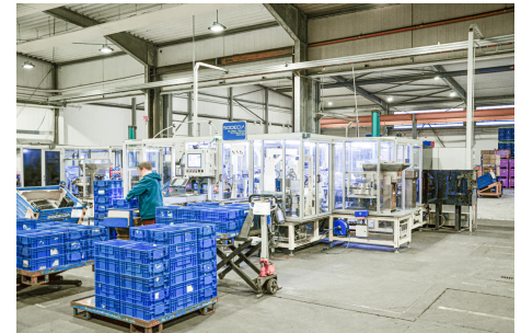
Am Standort in Attendorn stellt Sodecia Safety & Mobility mit rund 528 Mitarbeitern vor allem Modulquerträger für Elektrofahrzeuge und Sicherheitsbaugruppen für das Fahrzeuginnere her. Die Abbildung zeigt den Produktionsbereich für die Gurthöhenverstellsysteme. (Bild: ipf electronic gmbh)
