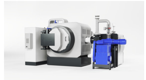
Die Sinterei verfügt über eine Vielzahl an Öfen, für deren Betrieb ein Kreislauf zur Kühlung des Stromanschlusses der Ofenheizungen sowie für die Mantelkühlungen der Öfen mit permanenter Durchflussüberwachung erforderlich ist. (Bild: ipf electronic gmbh)
