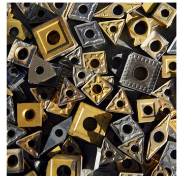
Bei der Zerspanung sind Wendeschneidplatten für die Metallbearbeitung mechanischen Beanspruchungen ausgesetzt. Die Rezeptur für die Schneidstoffe ist daher, abgesehen vom zu bearbeitenden Material, entscheidend für lange Standzeiten. (Bild: Adobe Stock)
