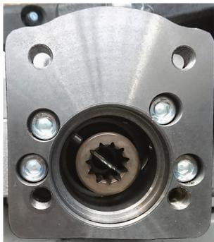
Seitlicher Blick in den Getriebeflansch. In der Mitte ist die innenverzahnte Kupplungswelle mit dem Holspannstift zu sehen, der vom Sensor für das Drehzahlsignal detektiert wird. (Bild: Carl Geringhoff GmbH & Co. KG)
