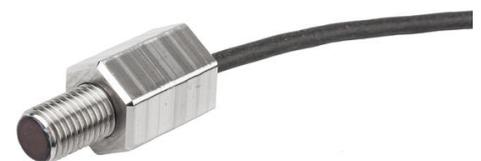
Die Sonderlösung von ipf electronic: Der induktive Sensor ist für Temperaturen von -25°C bis +85°C ausgelegt und hat einen maximalen Schaltabstand von 2mm. Besonders auffällig ist das Design durch die Kombination eines breiten Sechskantgehäuses mit einem 12mm langen M8-Gehäuse inklusive Gewinde.(Bild: ipf electronic gmbh)
