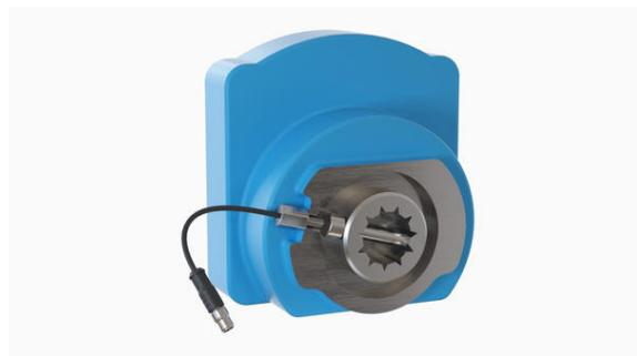
Die Grafik verdeutlicht die Einbausituation des Sensors am Getriebeflansch des Ölators. Die spezielle Konstruktion des Sensors ermöglicht es, die Lösung mit wenig Aufwand bis zum Anschlag in ein M8-Gewinde einzuschrauben und mit einem maximalen Anzugsmoment von 2,5Nm vibrationsfest zu montieren. (Bild: ipf electronic gmbh)
