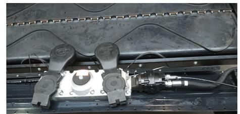
Die Drehzahlüberwachung des beim TruFlex-Bandschneidwerk in der Mitte sitzenden Messerantriebs übernimmt ein Sensor am Getriebeflansch (rechts). (Bild: Carl Geringhoff GmbH & Co. KG)
