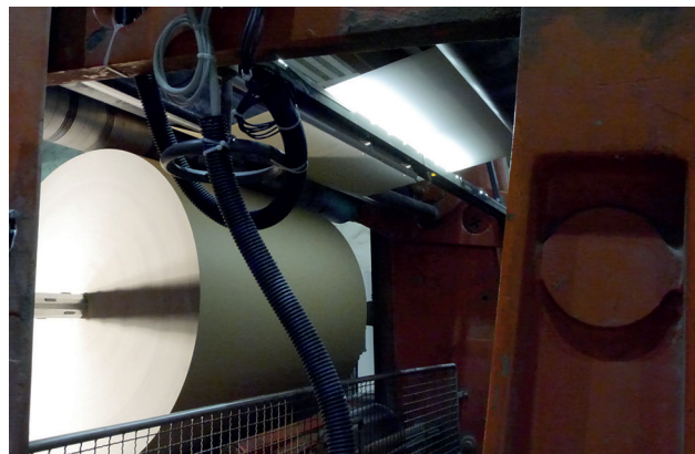
Na klinickém válci byla namontována dvě LED svítidla typu AO98E126 tak, aby zespoda osvětlovala pás papíru v celé jeho šířce.
