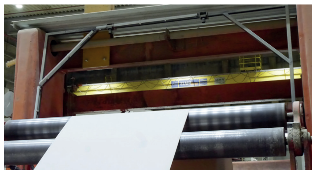
Řádkové kamery jsou nainstalované nad pásem papíru. Protože objektivy přístrojů mají ohniskovou vzdálenost 6 mm, může každá řádková kamera pokrýt jako oblast kontroly o něco více než polovinu pásu papíru.
