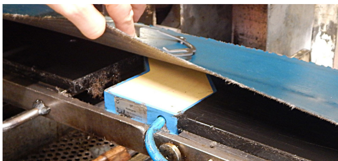
Indukční senzor zabudovaný pod dopravníkový pás. (Obrázek: ipf electronic)
