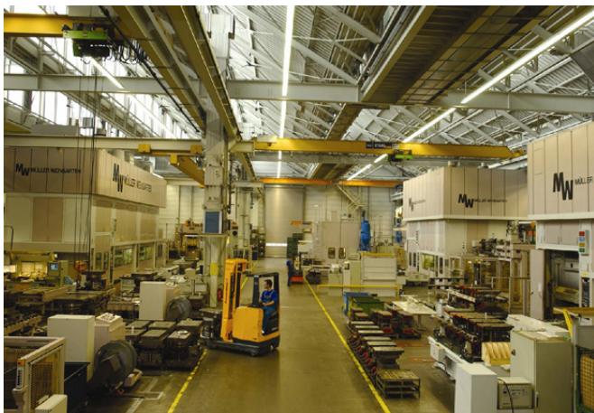
Lisovací závod Bühl (Bádensko-Württembersko) se v objektu firmy Schaeffler rozprostírá na několika halách, ve kterých jsou umístěny lisovací stroje o síle až několik tisíců tun pro výrobu dílů pro automobilový průmysl. (Obrázek: Schaeffler LuK)
