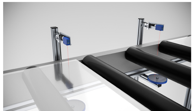
Detektion von transparenten Scheiben, die über eine Rollenbahn transportiert werden. Die extrem hohe Durchlässigkeit für sichtbare bzw. Infrarotstrahlung bei Glas macht hier keine Probleme, da das Material für die UV-Strahlung des OR270478 keine Durchlässigkeit aufweist.
