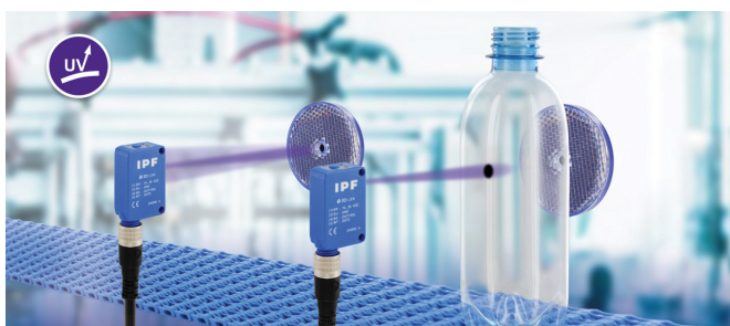
Auch bei der zuverlässigen Erfassung von PET-Flaschen in schnell laufenden Prozessen, wie sie aus der Getränkeindustrie bekannt sind, kann der OR270478 u.a. mit einer Schaltfrequenz von \leq 1\text{kHz} punkten.
