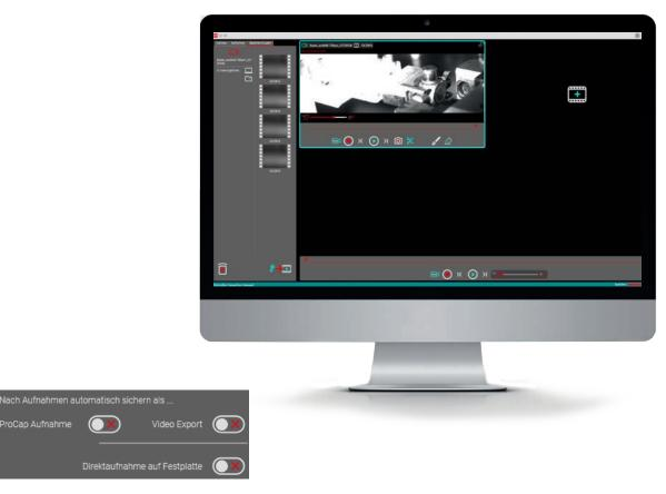
Der **Videoexport** erstellt eine Datei im avi-Format, die sich für den E-Mail-Versand eignet oder zur Dokumentation der Aufnahmen genutzt werden kann. Alle relevanten Zusatzinformationen zur Aufnahme (z. B. Zeitstempel, Signale von Sensoren) werden beim Speichern und dem Videoexport ebenfalls dauerhaft hinterlegt.
