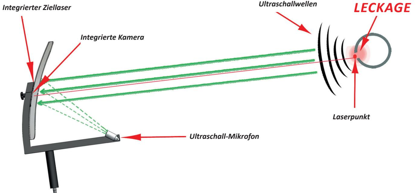
Durch die Bündelung der Ultraschallwellen im Parabolspiegel können selbst kleinste Leckagen von 0,8 l/min (ca. 8 € p. a.) in einer Entfernung bis 10...15 m punktgenau ( $\pm 15$  cm) lokalisiert werden. Die Form des Parabolspiegels gewährleistet, dass nur Ultraschallwellen der angepeilten Leckage ausgewertet werden. Störgeräusche werden auf ein Minimum reduziert.
