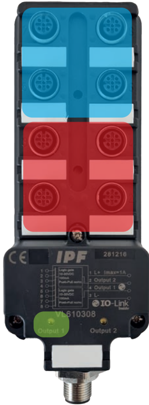
(Abbildung 1 mit farblicher Kennzeichnung: 8-fach-Logikmodul mit UND-Verknüpfung am Ausgang 1 für die Eingänge 1 bis 4. ODER-Verknüpfung für Eingänge 5 bis 8.)
