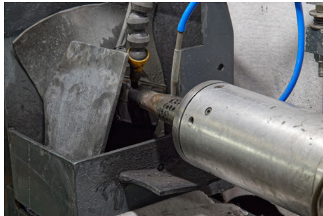
Mit dem Ultraschallkopf und einer aufgelöteten Negativmatrize wird die entsprechende Form mittels hoher Schwingungen und Borcarbit in einen Stein eingearbeitet.
