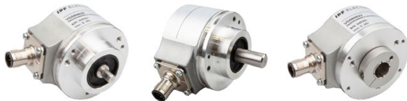
Parametrierbare inkrementale Drehgeber: VD589820 mit 6mm-Vollwelle, VD589821 mit 10mm-Vollwelle und VD589822 mit 12mm-Hohlwelle (von links).
