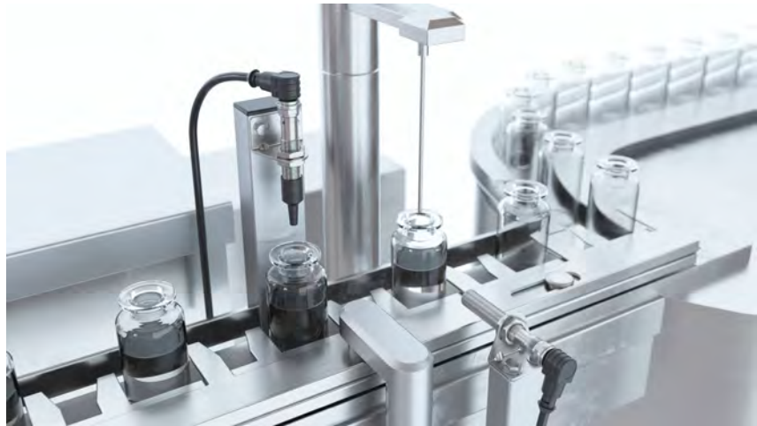
Abb. 32: Die Ultraschallsensoren der Reihe UT12 in der automatisierten Dosieranlage: Ein Sensor mit Schaltausgang dient zur Anwesenheitskontrolle. Das Gerät hinter der Dosiereinheit kontrolliert von oben die Füllstände durch die kleinen Flaschenöffnungen.
