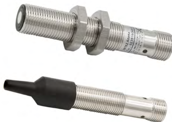
Abb. 31: Die Schalldüse am Sensorkopf des UT129021 fokussiert den Ultraschall, sodass Füllstände in Behältnissen mit sehr kleinen Öffnungen abgefragt werden können.
