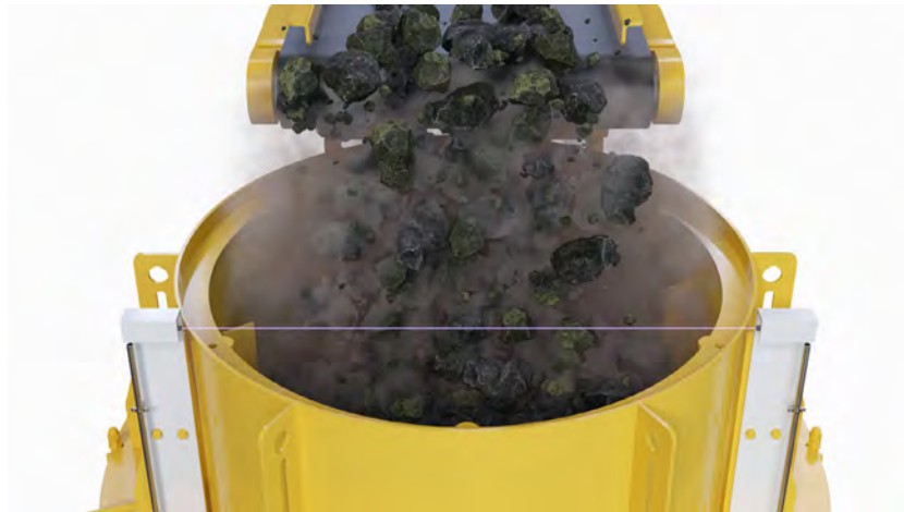
Abb. 24: Lichtschanke mit Einkanalverstärker (manuelle Betriebsart) zur Überfüllsicherung an einem Steinbrecher. Der Materialstrom löst beim Nachfüllen keine Schaltfunktion aus.
