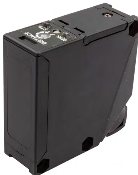
Abb. 21: Der OT595905 verfügt über einen maximalen Schaltabstand von 2500mm und eignet sich insbesondere für Materialien mit eher unregelmäßigen Oberflächenstrukturen.
