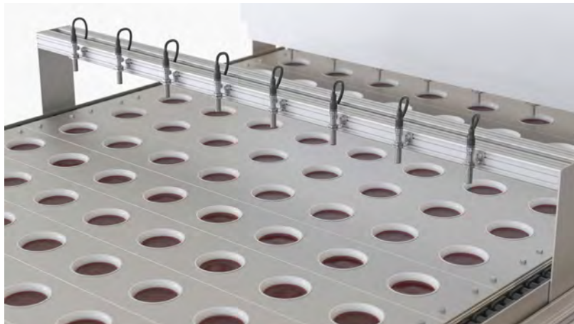
Abb. 19: Füllniveauekontrolle mit mehreren IO-Link-Ultraschallsensoren an einer Abfüllstation.
