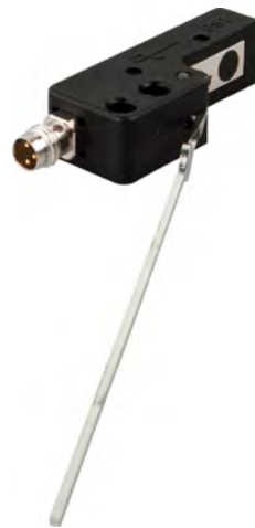
Abb. 26: Füllstandssensor FI520172 für einen Schwingförderer. Das Pendel besteht aus Edelstahl. Zu erkennen ist auch die Verdickung im oberen Bereich, die zur Abfrage mit dem im Halter integrierten induktiven Näherungsschalter dient.
