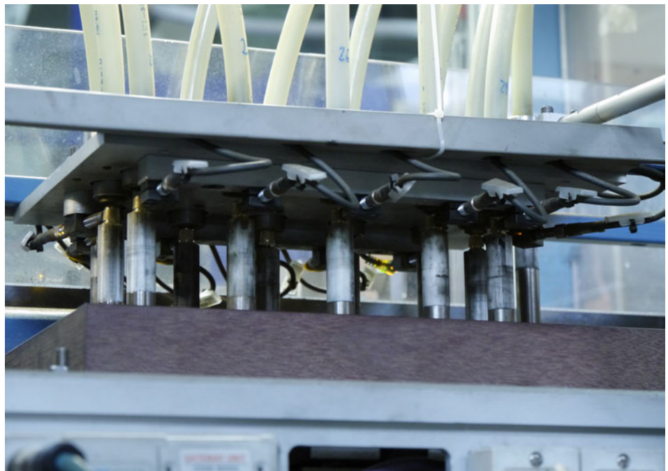
Bestückungseinrichtung für Messingbuchsen. Die induktiven Sensoren mit IO-Link-Schnittstelle informieren die übergeordnete SPS, wenn sie nicht mehr über eine ausreichende Funktionsreserve verfügen.
