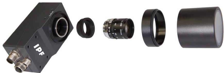
Kamerasensoren mit C-Mount-Anschluss ermöglichen eine freie Objektivwahl und somit ein breites Einsatzspektrum. Die einzelnen Komponenten zum Objektivanschluss: Zwischenring zur Variation der Naheinstellgrenze, Objektiv, Objektivschutzverlängerung und Objektivschutzkappe (von links).
