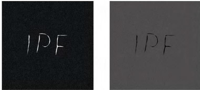
Kratzer auf Acrylglas. Links: Bei einer Dunkelfeld-Durchlichtbeleuchtung treten die Artefakte als helle Bereiche deutlich hervor. Rechts: Hellfeld-Durchlichtbeleuchtung.
