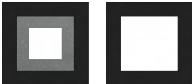
Tiefe Bohrung. Diffuses Durchlicht (entozentrisches Objektiv) (links). Telezentrisches Durchlicht (telezentrisches Objektiv) (rechts).
