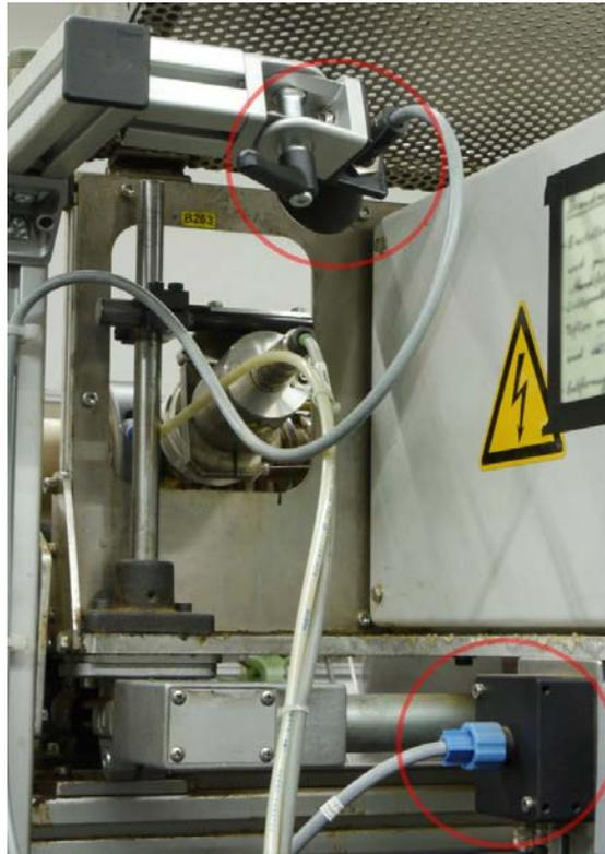
Abb. 6.: Ein Lichtleiter überträgt die Sendesignale vom Sensor (rechts unten) zur Reflexoptik (oben, Mitte)
