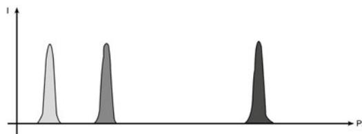
Signalverlauf über die Pixelzeile für drei unterschiedliche Objektabstände zum Gerät.
