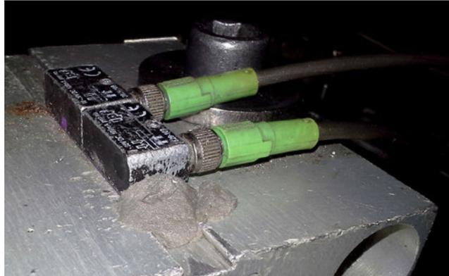
Magnetische Zylinder-Sensoren an einem speziellen Hydraulikzylinder. Die Sensoren müssen sehr hohen mechanischen Belastungen und Temperaturen bis +100°C standhalten.
