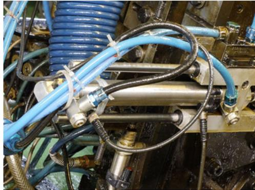
Zylinder-Sensoren in extrem ölhaltiger Umgebung an einer Maschine.
