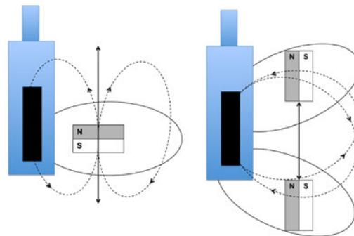
Richtige (links) und falsche (rechts) Ausrichtung eine Zylinder-Sensors.
