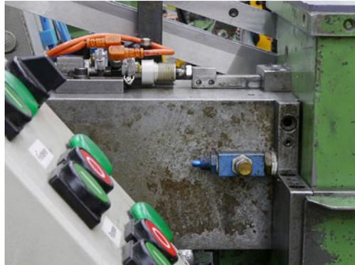
Zwei äußerst kompakte Sensoren auf einem extrem kurzen Pneumatikzylinder.
