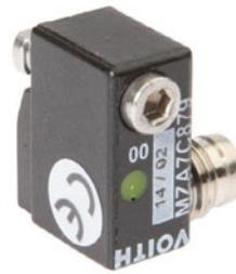
Als kundenspezifische Lösung an speziellen Hydraulikzylindern mit Gehäuse aus Zinkdruckguss und einem integrierten Positionsmagneten wird der **MZ150182** eingesetzt. Der Sensor muss sehr rauen Bedingungen, etwa an Spannwerkzeugen für Gesenke oder Wechselwerkzeuge, standhalten. Eine eigens entwickelte Befestigungslösung sorgt für einen sehr sicheren Halt des Sensors, selbst bei extremen Stößen und Vibrationen. Der Einsatztemperaturbereich dieser Sonderlösung reicht von -15°C bis +100°C.
