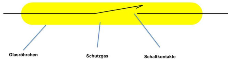
Schalter mit mechanischem Reed-Kontakt, der betätigt wird, wenn sich ein Magnetfeld in seiner Nähe befindet.
