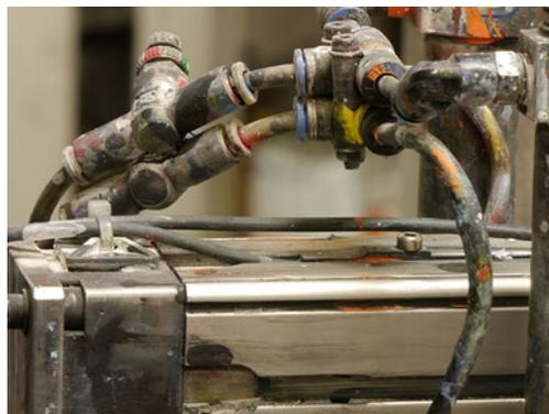
Die Sensoren widerstehen selbst Farbspritzern, eingetrockneten Farbbreständen oder Reinigungs- sowie Lösungsmitteln.
