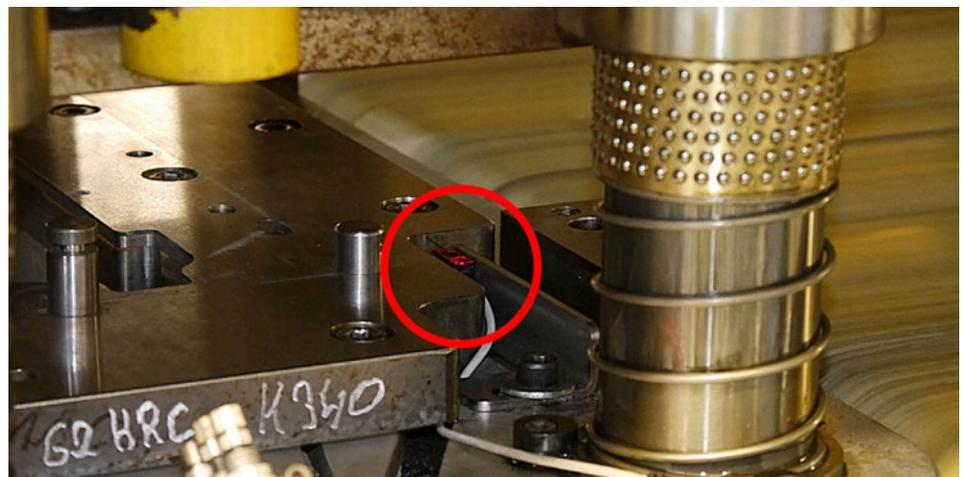
Aufgrund seiner Abmessungen kann der **OTQ90170** direkt in die Folgeverbundwerkzeuge der MLS-Stanzerei zur Vorschubkontrolle verbaut werden.
