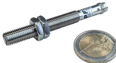
Der **UT089570** in M8, hier im Größenvergleich zu einer 2-Euro-Münze, hat eine Länge von 70mm. Die erreichbaren Schaltabstände liegen zwischen 20mm und 100mm.
