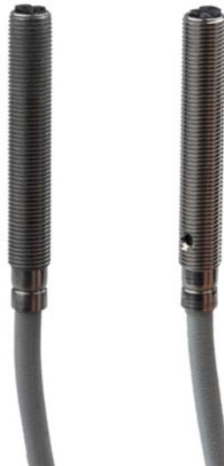
Der Sender **OS050075** (links) und der Empfänger **OE050175** (Empfänger) der Einweglichtschranke haben bei einer Länge von je 36mm lediglich einen Durchmesser von 5mm. Sender und Empfänger können in einem Abstand von bis zu 0,5m zueinander ausgerichtet werden.
