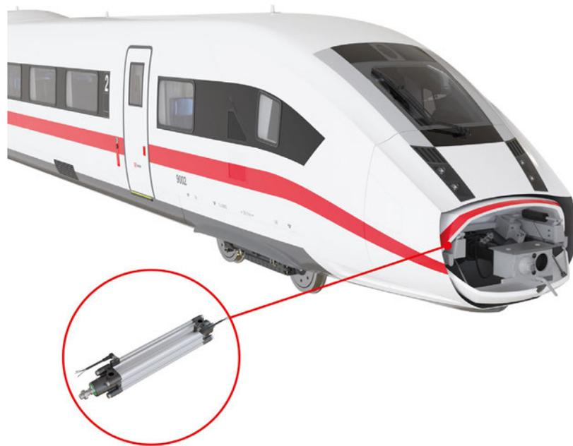
Durch GFK-Halbschalen aerodynamisch verkleidetes Kupplungssystem eines Triebwagens, die sich über Pneumatikzylinder öffnen lassen. Die Aufgabe: Eine stets zuverlässige Abfrage der Zylinderposition unter extrem rauen Betriebsbedingungen.
