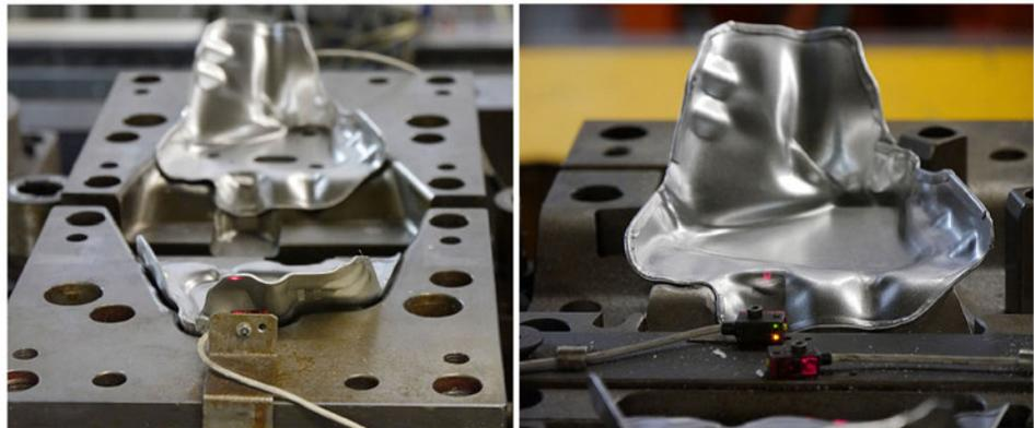
Hohe Prozesssicherheit: In verschiedenen Stationen des Folgeberbundwerkzeuges integrierte optische Sensoren stellen sicher, dass die jeweiligen Platinen zur Bearbeitung vorhanden sind.
