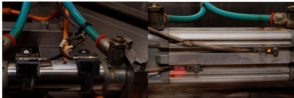
Robust und äußerst langlebig: Die Zylindersensoren MZR401A9 (links) und MZ0701A8 im Metallgehäuse ersetzen in einer Abfüllanlage konventionelle Geräte aus Kunststoff, da diese den regelmäßigen Reinigungszyklen mit einem alkoholhaltigen Reinigungsmittel nicht standhielten und daher häufiger ausgetauscht werden mussten.
