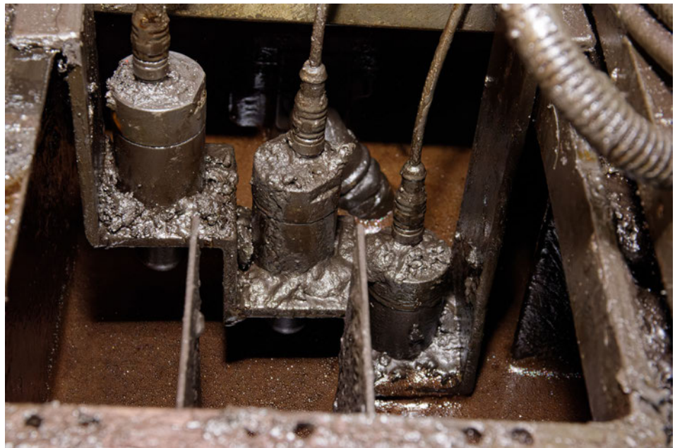
Kapazitive Füllstandssensoren FK920420 in einem Vorratsbehälter zur Permanentschmierung eines Stanzwerkzeuges.
