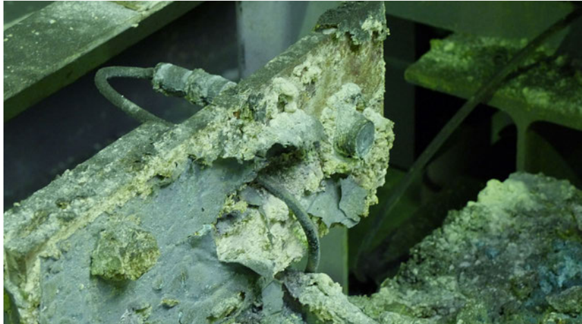
Kaum noch zu erkennen: Die säurehaltige Beize setzt den Laserlichtschranken in den Pufferzonen extrem zu.
