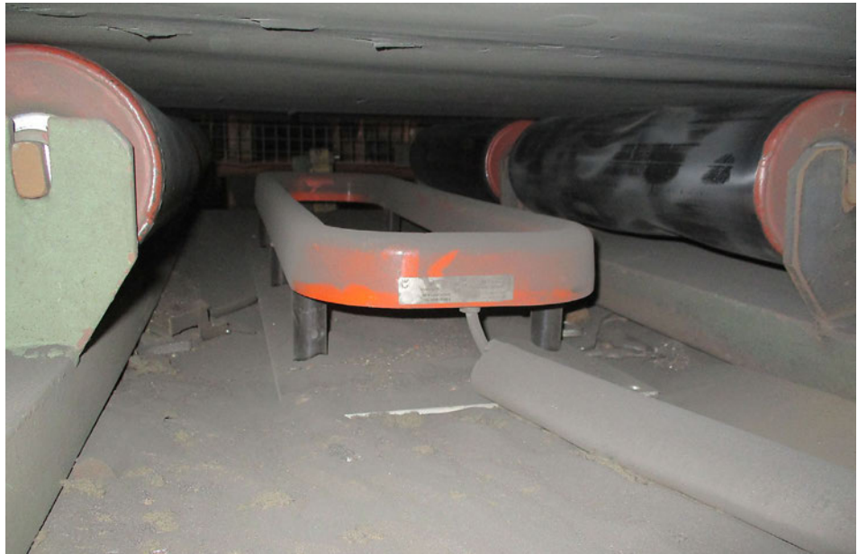
Die Detektorspule arbeitet selbst dann einwandfrei, wenn sich mit der Zeit Schmutz und Metallstaub darauf abgelagert. (Alle Bilder: ipf electronic gmbh)
