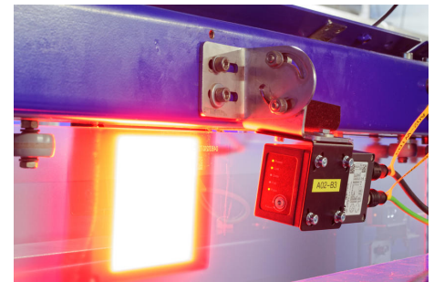
Einer der Kameras im Einsatz. Aufgrund von Durchlicht als Beleuchtungstechnik sind störende Reflexionen oder die Qualität der Beschriftung nicht mehr relevant für die zuverlässige Erkennung. (Bild: ipf electronic gmbh)
