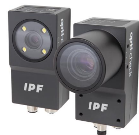
Die Serie OC53 besteht aus einer Reihe variabler Kamerasensoren, vom Kompaktgerät mit Objektiv, Bildaufnehmer und Beleuchtung (links), bis hin zu Geräten mit C-Mount-Objektivanschluss und integriertem Blitzcontroller zur Beleuchtungsteuerung (rechts). (Bild: ipf electronic gmbh)
