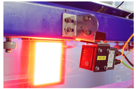
Une des caméras en action. Grâce à la lumière transmise comme technique d'éclairage, les réflexions gênantes ou la qualité de l'inscription n'ont plus d'importance pour la fiabilité de la reconnaissance. (Image : ipf electronic gmbh)
