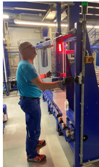
Au total, trois caméras sont installées dans l'établissement. L'illustration montre la zone d'introduction. Les substrats y sont marqués d'un code 2D et vérifiés directement par un système de caméras. (Prinz Optics GmbH)
