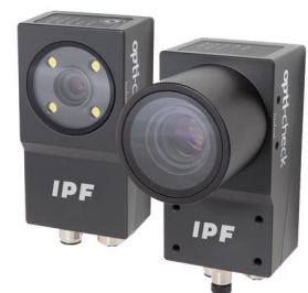
La serie OC53 è costituita da una gamma di sensori per fotocamere variabili, dai dispositivi compatti con obiettivo, sensore di immagine e illuminazione (a sinistra) ai dispositivi con attacco per obiettivo C e controller flash integrato per il controllo dell'illuminazione (a destra). (Immagine: ipf electronic gmbh)
