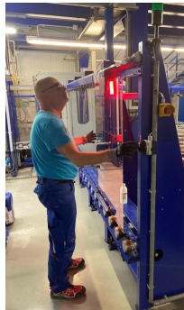
Nel sistema sono installate in totale tre telecamere. L'illustrazione mostra l'area di alimentazione. Qui i substrati vengono etichettati con un codice 2D e immediatamente verificati da un sistema di telecamere. (Prinz Optics GmbH)
