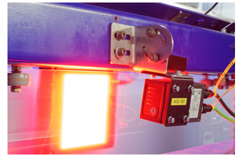
Una delle telecamere in uso. Grazie alla tecnologia di illuminazione a luce trasmessa, i riflessi di disturbo o la qualità dell'etichettatura non sono più rilevanti per un rilevamento affidabile. (Immagine: ipf electronic gmbh)
