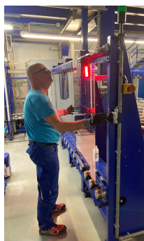
W systemie zainstalowane są łącznie trzy kamery. Ilustracja przedstawia obszar podawania. Tutaj substraty są oznaczane kodem 2D i natychmiast weryfikowane przez system kamer. (Prinz Optics GmbH)
