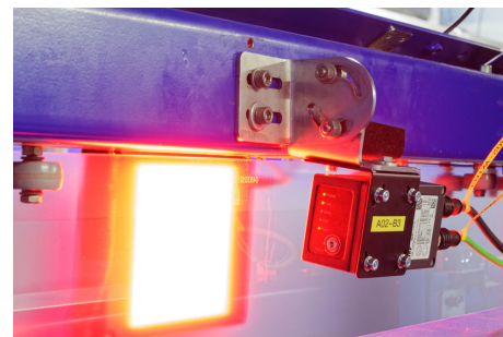
Uma das câmaras em funcionamento. Graças à luz transmitida como tecnologia de iluminação, os reflexos interferentes ou a qualidade da etiquetagem deixam de ser relevantes para uma deteção fiável. (Imagem: ipf electronic gmbh)
