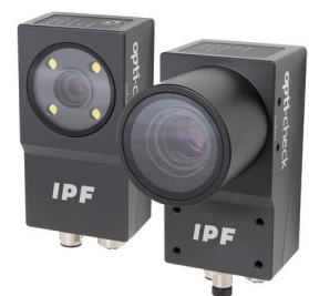
A série OC53 é composta por uma gama de sensores de câmara variáveis, desde dispositivos compactos com lente, sensor de imagem e iluminação (à esquerda) até dispositivos com ligação de lente de montagem em C e controlador de flash integrado para controlo da iluminação (à direita). (Imagem: ipf electronic gmbh)
