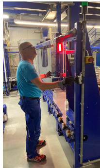
No total, estão instaladas três câmaras no sistema. A ilustração mostra a área de alimentação. Aqui, os substratos são etiquetados com um código 2D e imediatamente verificados por um sistema de câmaras. (Prinz Optics GmbH)
