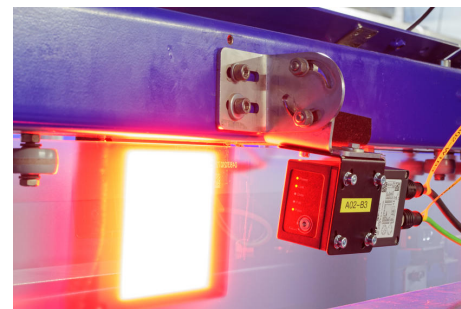
使用中的一台相机。由于采用了透射光作为照明技术，干扰反射或标签质量对于可靠的检测已不再重要。(图片：IPF 电子公司)
