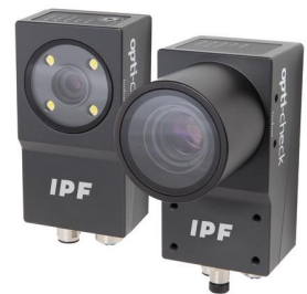
系列 OC53 系列包括一系列可变照相机传感器，从带镜头、图像传感器和照明的紧凑型设备（左）到带 C 型镜头连接和用于照明控制的集成闪光灯控制器的设备（右）。(图片：IPF 电子公司)
