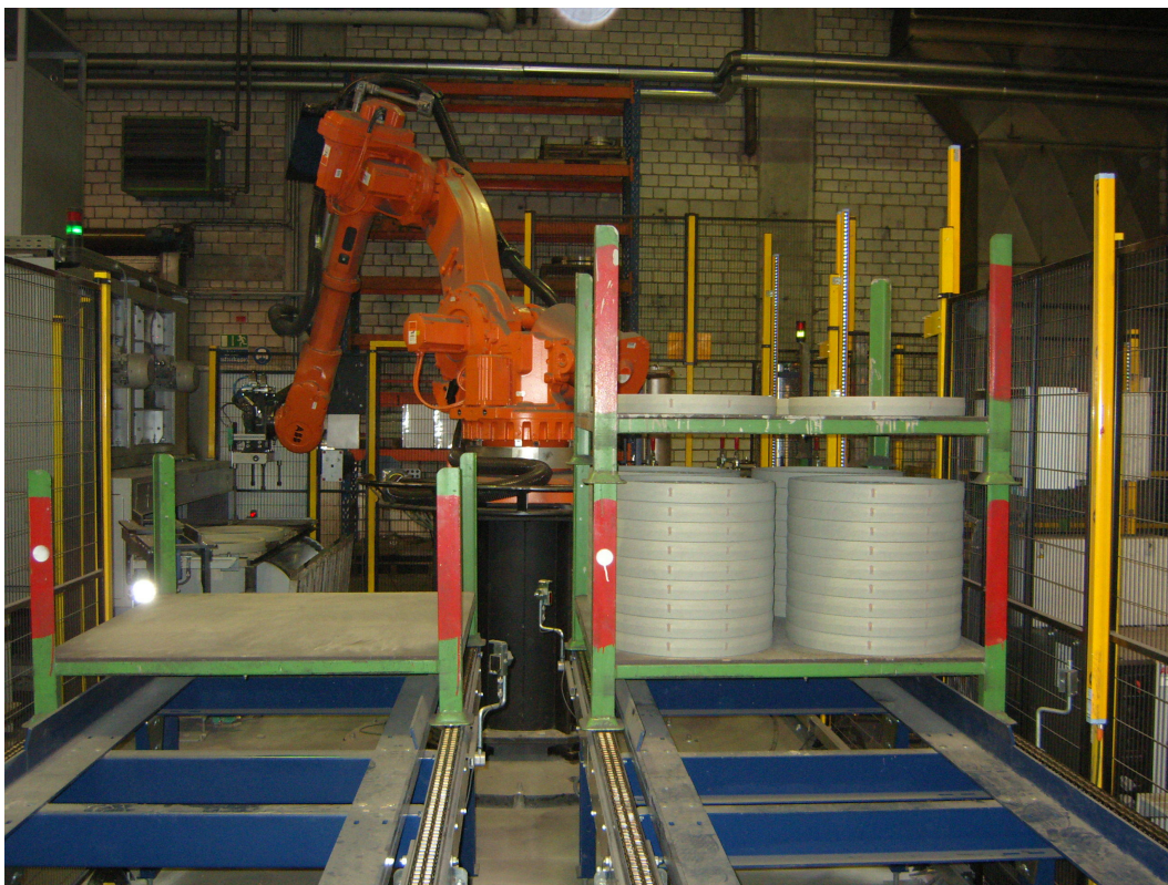
Carregamento automático de uma correia de forno Imagem: ipf electronic
