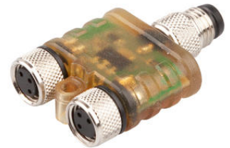
Namísto vnitřního zapojení se integrovaná elektronika VL150102 provádí propojení AND výstupů snímačů, takže v řídicí jednotce jsou vždy přítomny "čisté" signály. (Obrázek: ipf electronic)
