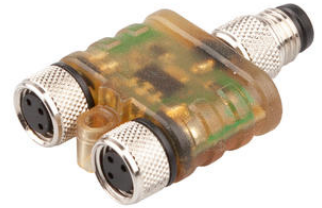
En lugar de cableado interno, la electrónica integrada del VL150102 realiza el enlace AND de las salidas de los sensores para que siempre haya señales "limpias" en el controlador. (Imagen: ipf electronic)
