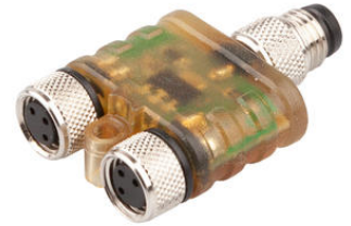
Au lieu d'un câblage interne, c'est l'électronique intégrée du VL150102 assure la liaison ET des sorties des capteurs, de sorte que des signaux "propres" sont toujours appliqués à la commande. (Image : ipf electronic)
