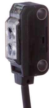
Os sensores ópticos OTQ80100 e OTQ80200 são muito compactos e, graças à distância de comutação ajustável, são adequados para utilização em diferentes cabeças de manuseamento com diferentes estações de pinças. (Imagem: ipf electronic)
