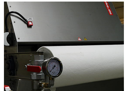
Côté entrée du non-tissé filtrant : Un palpeur optique d'ipf electronic surveille la présence du non-tissé filtrant avec un signal permanent. Lorsque le non-tissé filtrant est usé, le signal du capteur diminue et signale ainsi à l'API de l'installation qu'un nouveau non-tissé doit être mis en place.
