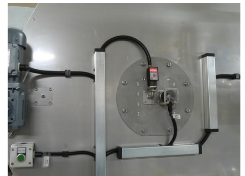
过滤绒布上方用于液位控制的压力传感器特写。
