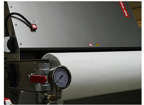
过滤绒的入口侧：来自 ipf electronic 的光学传感器通过永久存在的信号监测过滤绒的存在。如果过滤绒被用完，传感器发出的信号就会消失，从而向系统的 PLC 发出需要插入新过滤绒的信号。
