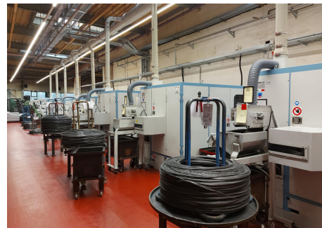
Większość czujników jest używana w maszynach w tłoczni SPAX, ponieważ systemy te mają duże zapotrzebowanie na sprężone powietrze.
