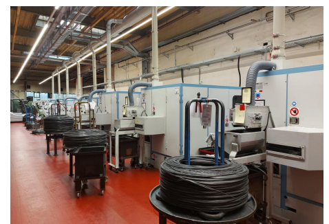
大部分传感器用于 SPAX 冲压车间的机器，因为这些系统对压缩空气的需求量很大。
