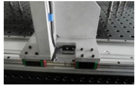
Flexibel einsetzbare magnetische Auflagepunkte sorgen für eine zuverlässige Fixierung der Blechplatten auf dem Grundtisch.
