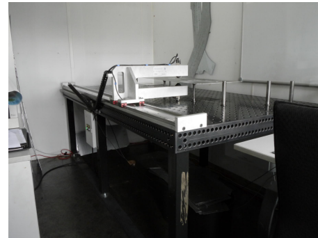
W użyciu od wiosny 2016 r.: Specjalne urządzenie testujące służy do sprawdzania grubości materiału półfabrykatów z blachy.
