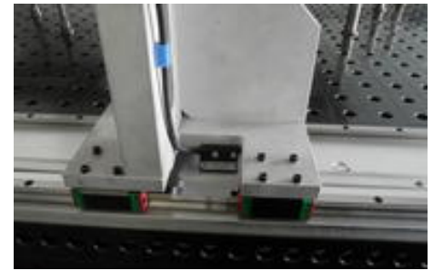
Elastyczne magnetyczne punkty podparcia zapewniają niezawodne mocowanie wykrojów blachy na stole bazowym.
