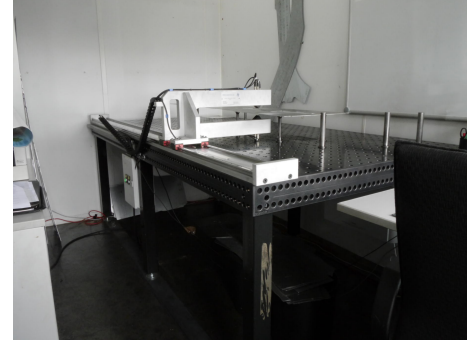
自 2016 年春季开始使用：专用检测设备用于检测整个金属板材坯料的材料厚度。
