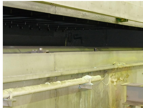
Jeweils drei parallel betriebene induktive Sensoren sind am Ein- und Ausgang der Beizkammer positioniert. Die spezielle Anordnung gewährleistet, dass ein größerer Bereich der Kupferplatte von der Unterseite abgefragt werden kann und somit mindestens ein Sensor anspricht.
