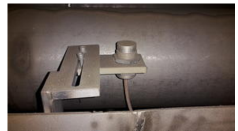
Die induktiven Sensoren verfügen über eine aktive Fläche aus Edelstahl, sind daher sehr robust (Schutzklasse IP68) und für Umgebungstemperaturen bis +70° C ausgelegt.
