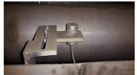
Los sensores inductivos tienen una superficie activa de acero inoxidable, por lo que son muy robustos (clase de protección IP68) y están diseñados para temperaturas ambiente de hasta +70° C.
