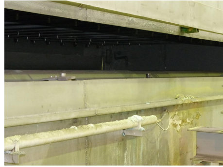
En la entrada y la salida de la cámara de decapado se colocan tres sensores inductivos que funcionan en paralelo. La disposición especial garantiza que se pueda explorar una mayor superficie de la placa de cobre desde la parte inferior y, por tanto, que responda al menos un sensor.
