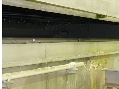
Trois capteurs inductifs fonctionnant en parallèle sont positionnés à l'entrée et à la sortie de la chambre de décapage. Cette disposition spéciale garantit qu'une plus grande zone de la plaque de cuivre peut être interrogée par la face inférieure et qu'au moins un capteur réagit donc.
