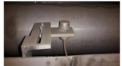
Les détecteurs inductifs disposent d'une surface active en acier inoxydable, ils sont donc très robustes (classe de protection IP68) et conçus pour des températures ambiantes allant jusqu'à +70° C. Ils peuvent être utilisés dans des environnements difficiles.
