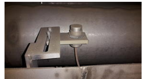
Czujniki indukcyjne mają aktywną powierzchnię wykonaną ze stali nierdzewnej, dzięki czemu są bardzo wytrzymałe (stopień ochrony IP68) i zaprojektowane do pracy w temperaturach otoczenia do +70°C.
