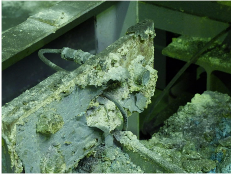
可以清楚地看到，酸性污渍对缓冲区内内的激光光栅造成了极大的破坏，但安装在辊道上方的传感器仍能可靠地工作。
