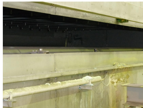
三个并联运行的感应式传感器分别位于酸洗室的入口和出口处。这种特殊的布置可确保从底部扫描到铜板的更大面积，因此至少有一个传感器做出响应。
