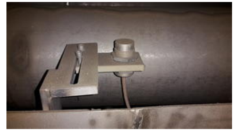
电感式传感器的有效表面由不锈钢制成，因此非常坚固（防护等级 IP68），可承受高达 +70°C 的环境温度。
