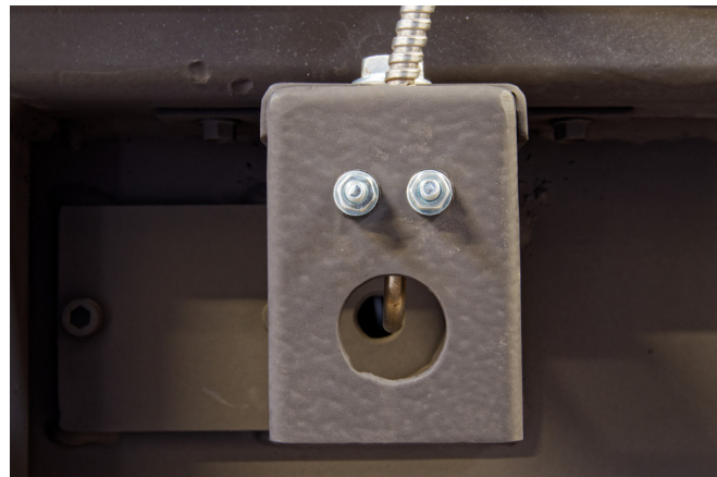
Zur Füllstandskontrolle musste die Lichtschranke, im Unterschied zum Drehflügel-Füllstandsmelder, seitlich platziert werden, damit der Lichtleiter, wie hier, durch eine Bohrung den Feuerraum detektieren kann. (Bild: ipf electronic)
