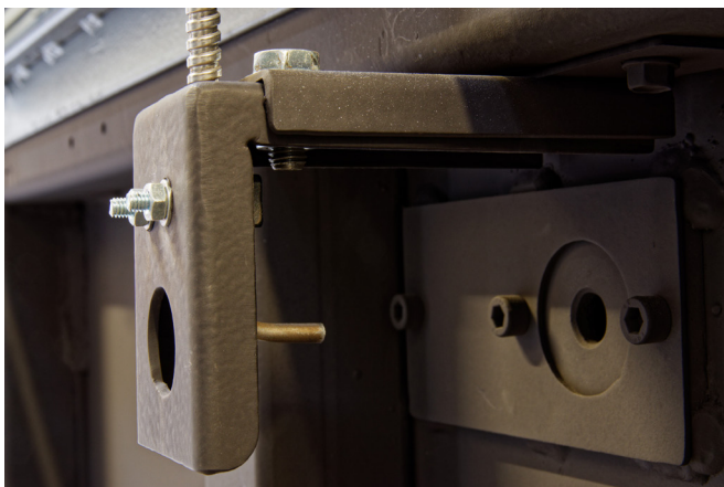
Detailansicht des Lichtleiters für den Empfänger in gebogener Ausführung. Der Lichtleiterkopf befindet sich in einiger Entfernung von der Bohrung zum Feuerraum. (Bild: ipf electronic)
