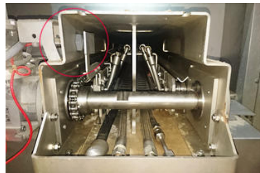
Dva indukční senzory IB1201K0 pro lineární měření a zjišťování směru otáčení jsou namontovány před kódovacím kotoučem na hnacím hřídeli (vlevo) řetězového pohonu. (Obrázek: IBS Paper Performance Group)
