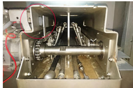
Les deux capteurs inductifs IB1201K0 pour la mesure de la course et l'interrogation du sens de rotation sont montés devant un disque de codage sur l'arbre d'entraînement (à gauche) de la transmission par chaîne. (Photo : IBS Paper Performance Group)
