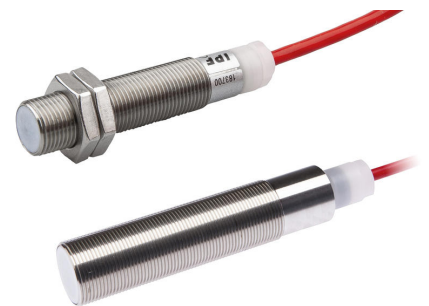
Sensores indutivos resistentes às alterações climáticas, como o IB1201K0 (acima) e IB1804K0 da ipf electronic são absolutamente selados com a classe de protecção IP69k e podem suportar rápidas flutuações de temperatura e alterações na gama de -25° C a +120° C. (Imagem: ipf electronic gmbh)
