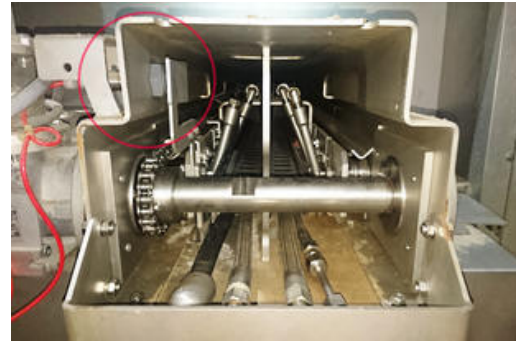
Os dois sensores indutivos IB1201K0 para medição do percurso e consulta do sentido de rotação estão montados em frente a um disco de codificação no eixo de acionamento (à esquerda) da transmissão por corrente. (Imagem: IBS Paper Performance Group)
