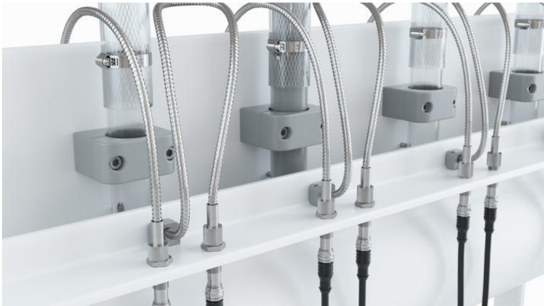
Pokud je infračervený světelný paprsek světelné závory, která se skládá z optického vysílače OS126020 a optického přijímače OE126020 přerušena v důsledku zakalení chladicí kapaliny v jedné ze skleněných trubic (druhá trubka zleva), příslušný vyhodnocovací kanál připojovací jednotky vygeneruje spínací signál.
